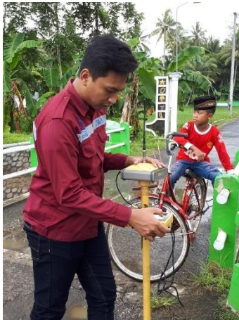
Gambar 22. Pengukuran GPS RTK Lokasi 8
