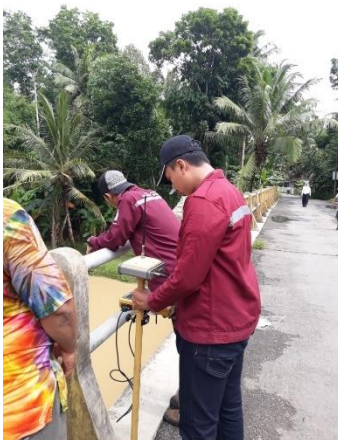
Gambar 19. Pengukuran GPS RTK Lokasi 6
