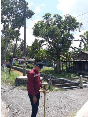
Gambar 21. Pengukuran GPS RTK Lokasi 7
