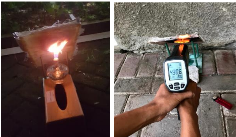
Gambar 4.11 Pengujian Ketahanan Bakar Ore B Burning (a) Peletakan Spesimen (b) Temperatur Bakar
