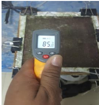
Gambar 3.12 Proses Curing dan Pengamatan Temperatur
