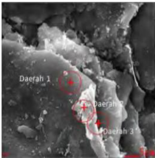
Gambar 2.14 EDX Aluminium Hidroksida (Zainuri, 2006)
