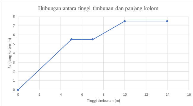
Gambar 6.7 Hubungan antara tinggi timbunan dan panjang kolom
