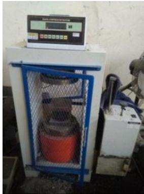
**Gambar 3. 13** Mesin Uji Kompresi
