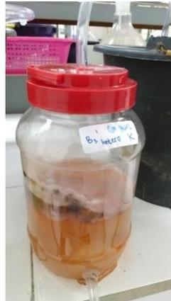
Gambar 4.4 Kondisi reaktor heterotrof dengan konsentrasi 60 mg/L
