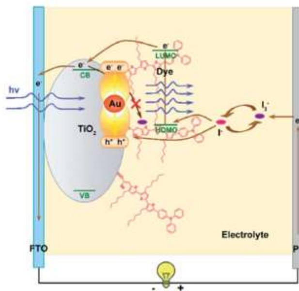
Gambar 2.4 Skema konfigurasi fotoanoda DSSC berbasis \text{TiO}_2 -Au dengan efek LSPR dari AuNPs, dan proses transfernya (Li dkk., 2013).
