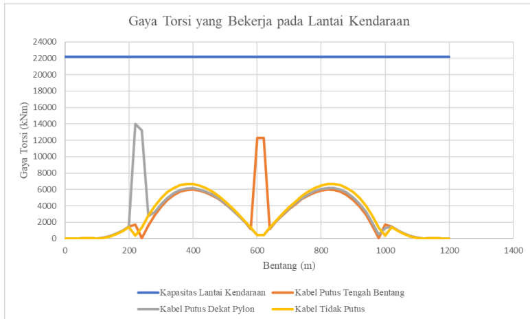
Gambar 4.101 Gaya Torsi yang Bekerja pada Lantai Kendaraan
