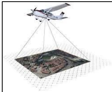
Gambar 2. 1 Proses Pengambilan Foto Udara (Sutanto 1994)
