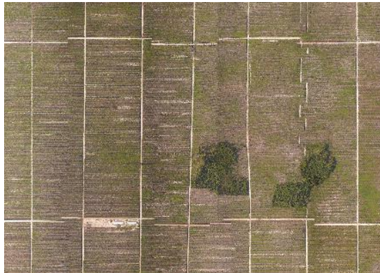
Gambar 4. 21 Objek jalan diperkebunan kelapa sawit yang tidak terbentuk dengan sempurna (DG)
