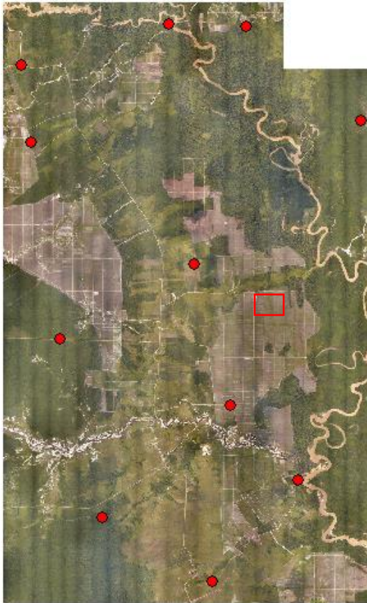
Gambar 4. 17 Hasil pengolahan dengan metode gabungan menggunakan 11 titik ikat
