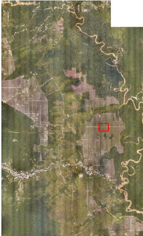
Gambar 4. 13 Hasil pengolahan dengan metode gabungan tanpa menggunakan titik ikat
