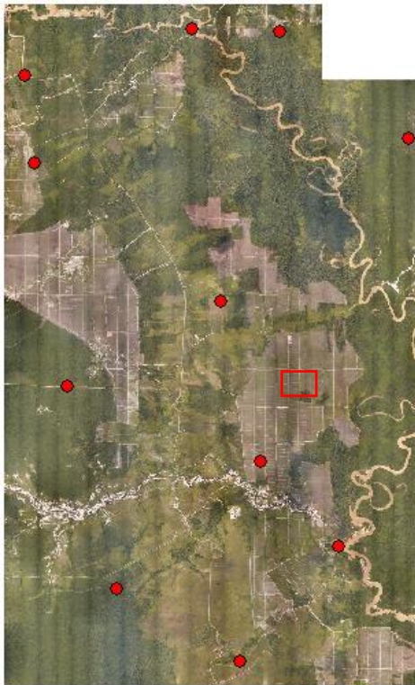
Gambar 4. 11 Hasil pengolahan dengan metode DG menggunakan 11 titik ikat
