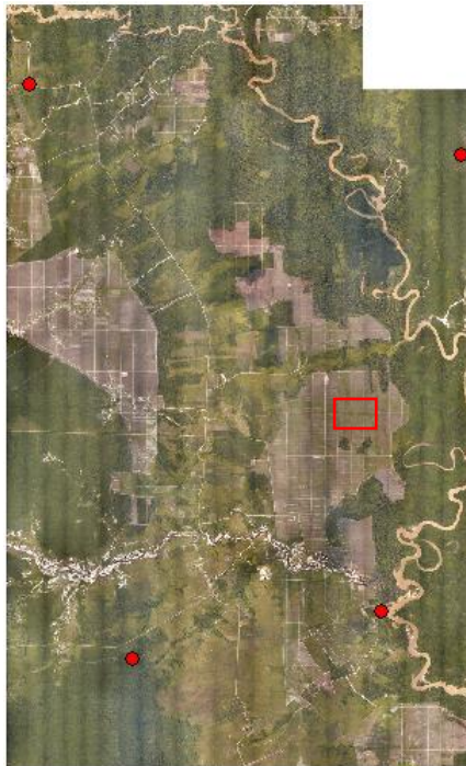
Gambar 4. 15 Hasil pengolahan dengan metode gabungan menggunakan 4 titik ikat
