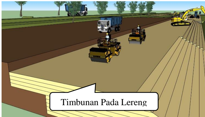
Gambar 4. 19 Kombinasi Alat Berat Pekerjaan Timbunan
