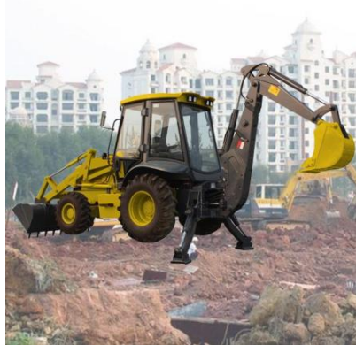
Gambar 2. 22 excavator untuk Galian
