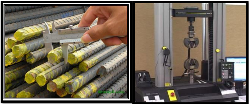
Gambar 2. 7. Uji diameter fisik dan Uji tarik
