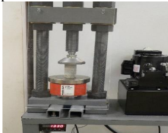
Gambar 4. 6 Alat Tes Uji Tekan
