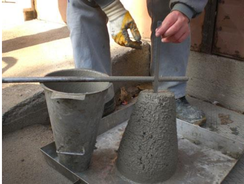
Gambar 5. 1. Uji Slump Test pada Beton Segar[13]
