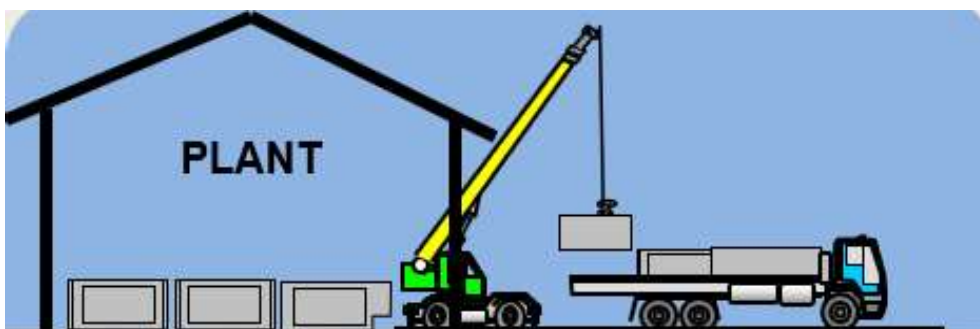
Gambar 4.8 Distribusi girder dengan menggunakan truk trailer
