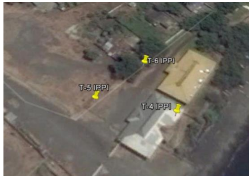
Gambar 4.1 Denah Titik Penyelidikan Tanah (Sumber : Data Proyek)
