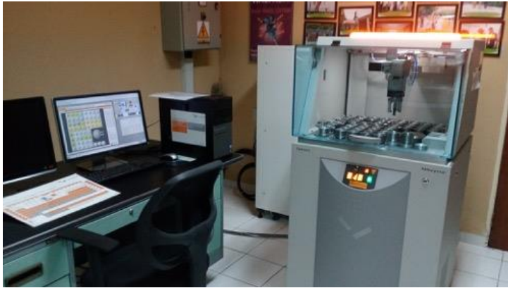
Gambar 2.1 XRF Spectrometer Epsilon5 PANalytical (Diambil pada 29 Desember 2018)
