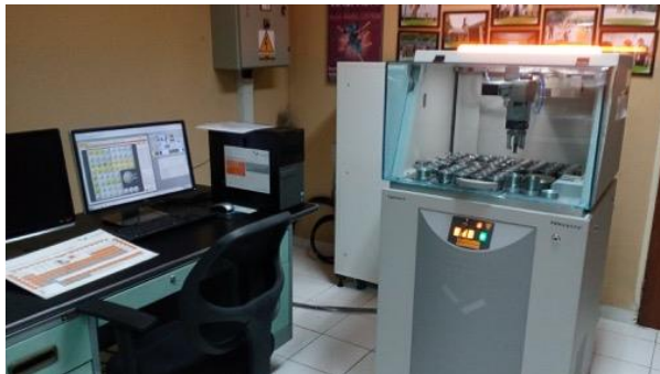
Gambar 3.7 XRF Spectrometer Epsilon5 PANalytical (Diambil pada 29 Desember 2018)
