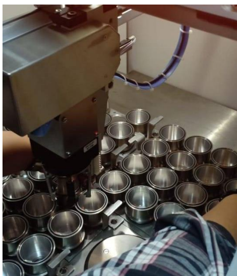
Proses memasukan sampel ke XRF
