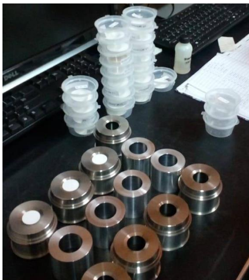
Proses memasukan sampel ke Wadah XRF
