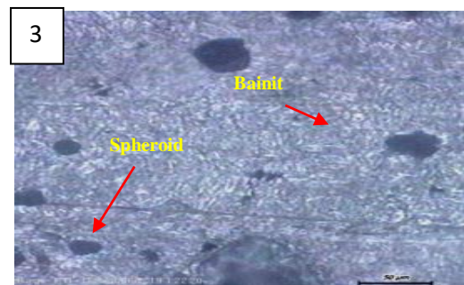
Gambar 4.3 Hasil uji metalografi spesimen tempering dengan Temperatur 482 0 C perbesaran 500x menggunakan waktu tahan: (1)1 jam, (2)2 jam, (3)4 jam
