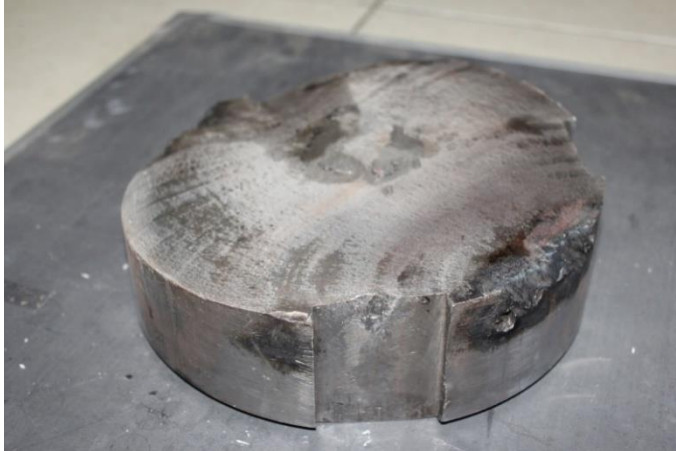
Gambar 3.2 Poros mesin uap yang patah
