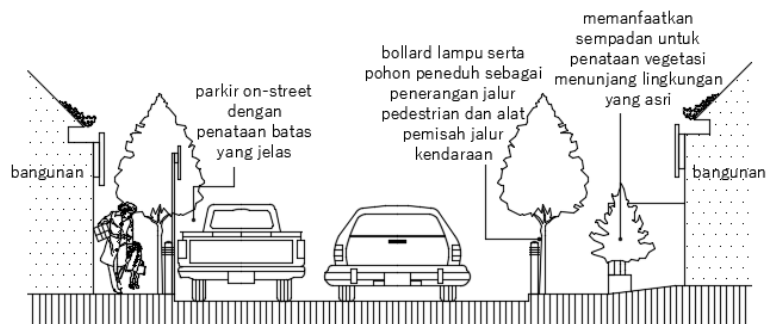
Gambar 5.10. Potongan Jalan Kalimantan
