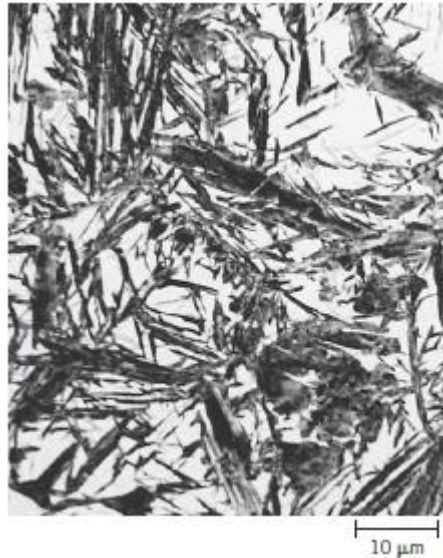
Gambar 2.24 Struktur dari Martensit (Calister, 2008)
