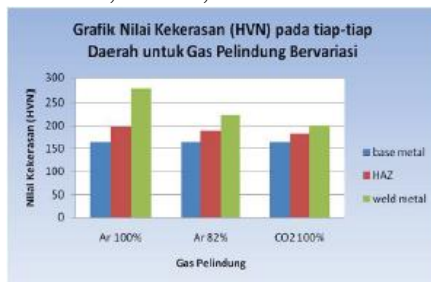
Gambar 2.26 Nilai kekerasan pada tiap-tiap daerah untuk gas pelindung bervariasi.
