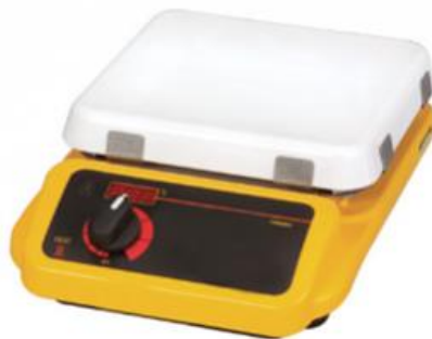
Gambar 3.16 Hot Plate dan Stirrer
