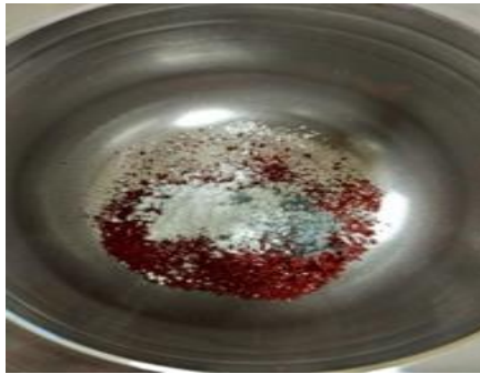
Gambar 3.21 Pencampuran Bahan Barium Heksaferrit
