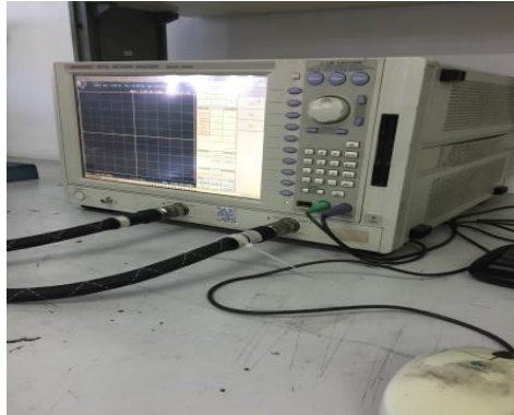
Gambar 3.20 Alat Uji VNA
