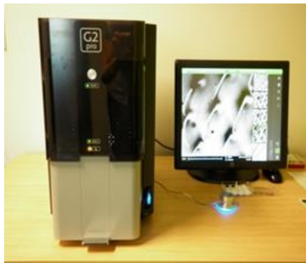
Gambar 3.17 Alat Uji SEM
