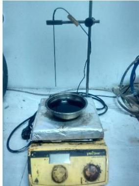
**Gambar 3.17** *Hot Plate Magnetik Stirrer*
