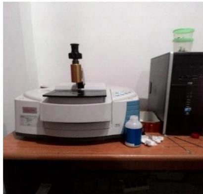
**Gambar 3.20** Mesin FTIR
