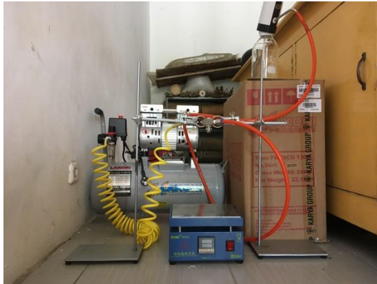
Gambar 3. 2 Rangkaian Alat Kerja Spray Pyrolysis
