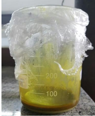
Gambar 4.2 Campuran Larutan \text{PdCl}_2 dan Serbuk Al-MCM-41/keramik
