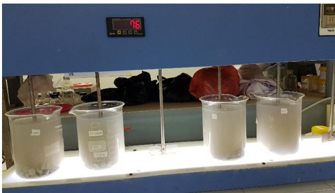
Gambar 3.11 Pengulangan Proses Batch Menggunakan Media Kapur-Semen Rasio 6:1
