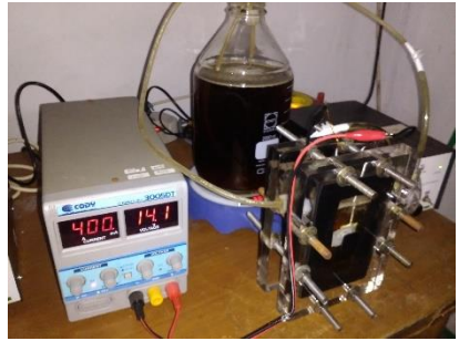
Gambar L3.1 Operasi Reaktor Elektrooksidasi
