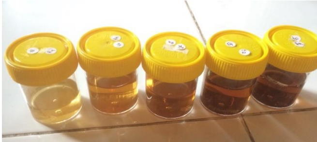
Gambar LD.6 Sampel Sebelum dan Setelah Pengolahan Elektrokimia
