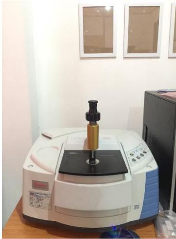
**Gambar 3.4** Alat Uji FTIR
