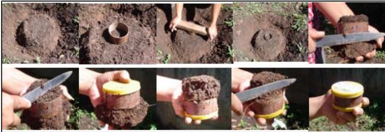
Gambar 3.4 Tahapan Pengambilan Sampel Tanah Menggunakan Alat Ring Sampel (bergerak dari pojok kiri atas ke pojok kanan bawah) Sumber : Suganda et al. , 2006
