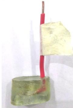
**Gambar 3.9** Spesimen uji yang telah disambungkan dengan kawat kabel tembaga dan *dimounting*
