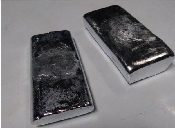
**Gambar 4.1** Anoda Korban Seng Hasil Pengecoran *Die Casting*
