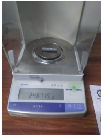
**Gambar 3.17** Spesimen hasil pengujian yang sudah dibersihkan lalu ditimbang
