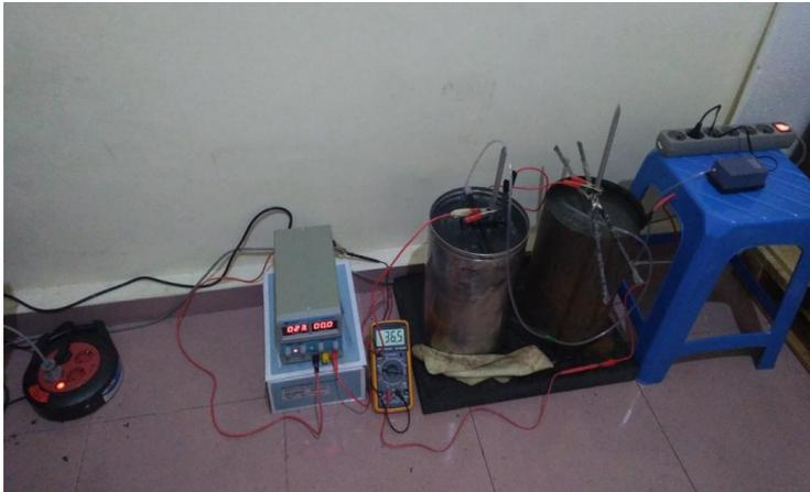
**Gambar 3.16** Rangkaian Pengujian Korosi Secara Elektrokimia Jangka Pendek
