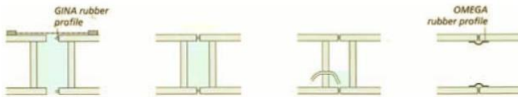
Gambar 5.30 Proses penyambungan antar segmen dengan rubber gaskets
