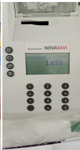
Gambar LD. 8 Analisis Parameter COD
