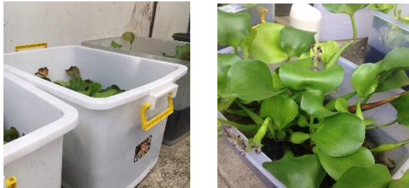
Gambar 3. 2 (a) Reaktor yang digunakan pada tahap propagasi dan (b) reaktor tahap aklimatisasi dan penelitian utama
