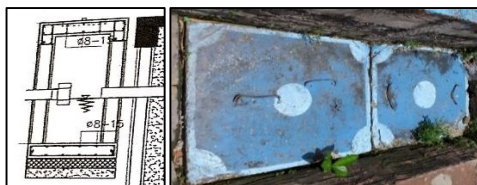
Gambar 4.14 Bak Inlet ; (a) Desain Perencanaan, dan; (b) Implementasi Di Lapangan
