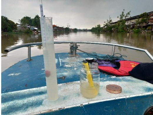
Pengukuran densitas, pH, dan suhu air sungai
