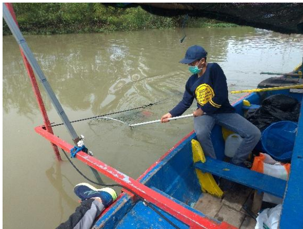
Proses penarikan Manta Trawl
