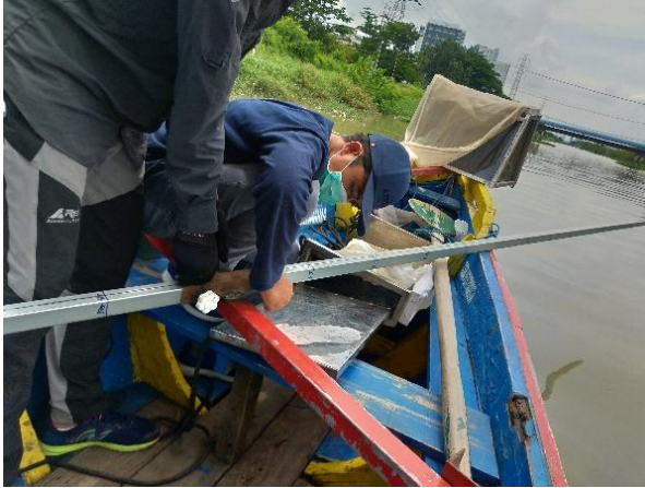
Proses pemasangan Manta Trawl
