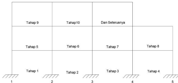
Gambar 2. 18 Metode Ereksi Arah Horizontal
