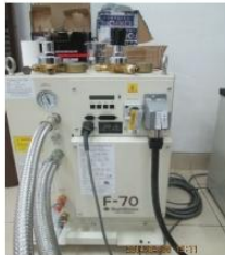
Kompresor gas Helium
