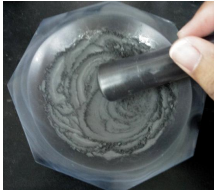
Gambar 3.2 Proses sintesis serbuk (Se,Te) dan Fe(Se,Te)
