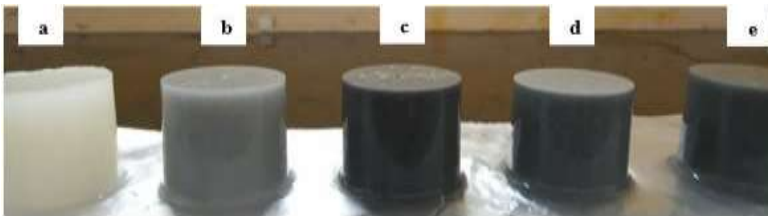
Gambar 4.7 Kemampuan Biokomposit Dalam Mempertahankan Bentuk Sesuai Cetakan (a) 0% rGO; (b) 0,4% rGO; (c) 0,8% rGO; (d) 1,2% rGO; (e) 1,6% rGO
