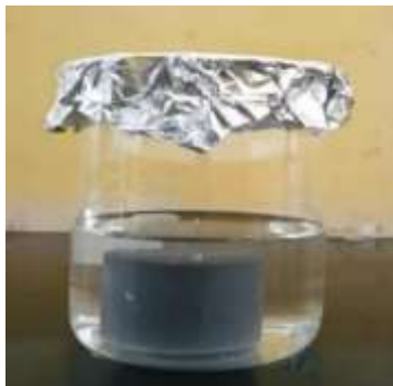
Gambar 4.8 Degradasi Biokomposit Alginat/PVA/0,8% rGO Pada Lingkungan Phosphate Buffered Saline
