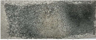
Gambar 4. 27 Katoda Pt Setelah Elektrolisis Filtrat dengan Oksidasi H 2 O 2 + UV pH 3
