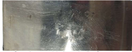
Gambar 4. 28 Anoda Pt Setelah Elektrolisis Filtrat dengan Oksidasi H 2 O 2 + UV pH 3
