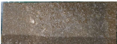
Gambar 4. 13 Katoda Pt Setelah Elektrolisis Filtrat Tanpa Oksidasi pH 4
