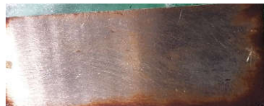
Gambar 4. 14 Anoda Pt Setelah Elektrolisis Filtrat Tanpa Oksidasi pH 4
