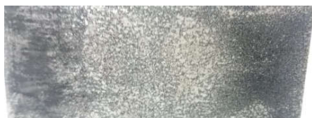
Gambar 4. 25 Katoda Pt Setelah Elektrolisis Filtrat dengan Oksidasi H 2 O 2 pH 3
