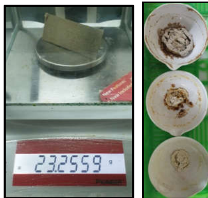
Gambar LC. 7 Hasil Proses Elektrolisis (a) Penimbangan Elektroda Setelah Elektrolisis (b) Endapan di Feed Tank Setelah Kering
