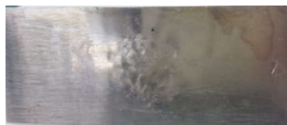
Gambar 4. 26 Anoda Pt Setelah Elektrolisis Filtrat dengan Oksidasi H 2 O 2 pH 3
