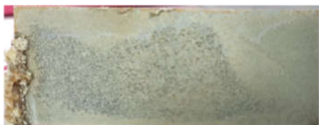
Gambar 4. 23 Katoda Pt Setelah Elektrolisis Filtrat Tanpa Oksidasi pH 3
