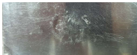
Gambar 4. 24 Anoda Pt Setelah Elektrolisis Filtrat Tanpa Oksidasi pH 3
