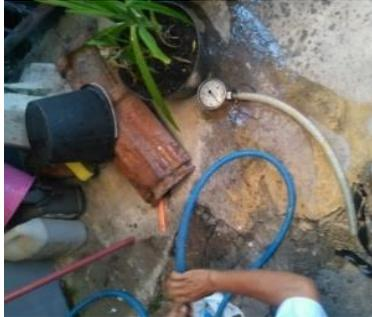
Gambar 4. 6 Pengukuran Tekanan di Keran Depan Rumah Pelanggan
