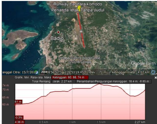
Gambar 4.45. Profil Ketinggian Runway Bandara Komodo
