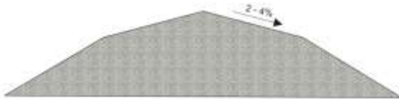
Gambar 2.2 Kemiringan Lereng dan Rasio Vertikal-Horisontal Sumber : Permen PU no 3 tahun 2013
