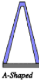
Gambar 3. 7 Bentuk pylon menggunakan bentuk A-Tower
