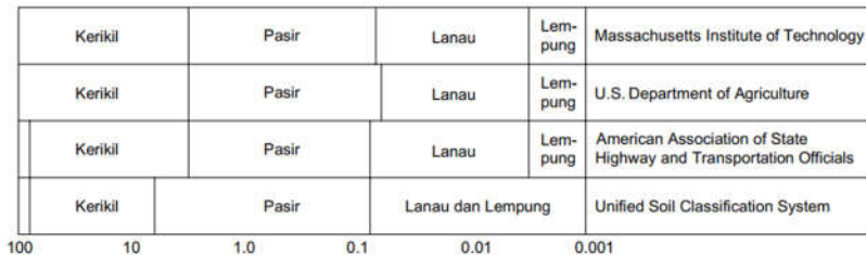
Gambar 2. 1 Batasan-batasan ukuran golongan tanah menurut beberapa sistem (Sumber: Braja M. Das)
