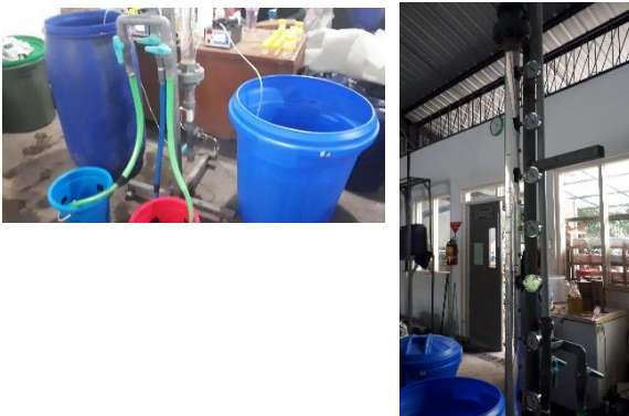
Gambar 6. Reaktor Fluidized Bed yang digunakan
