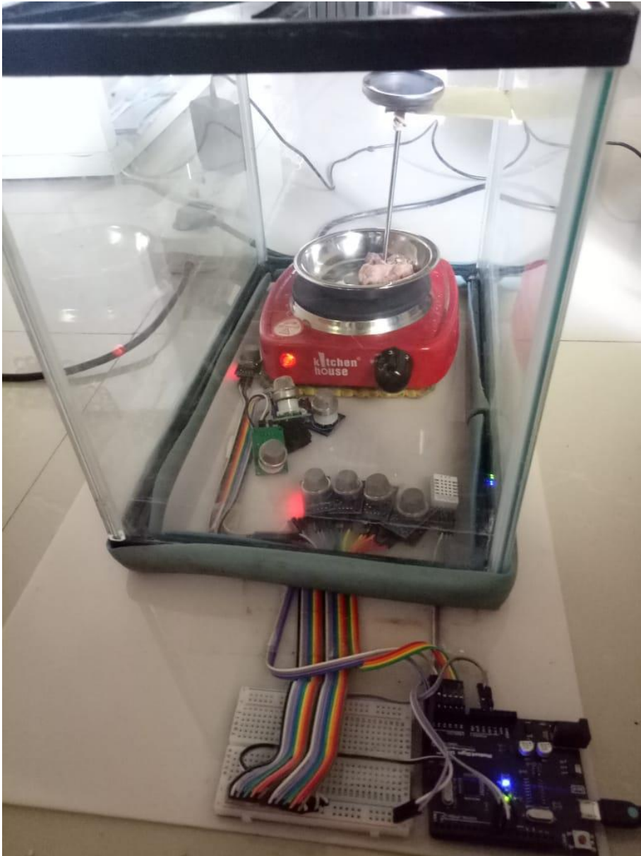
Gambar 5.3 Proses pengambilan data daging menggunakan electronic nose dengan suhu 55°C
