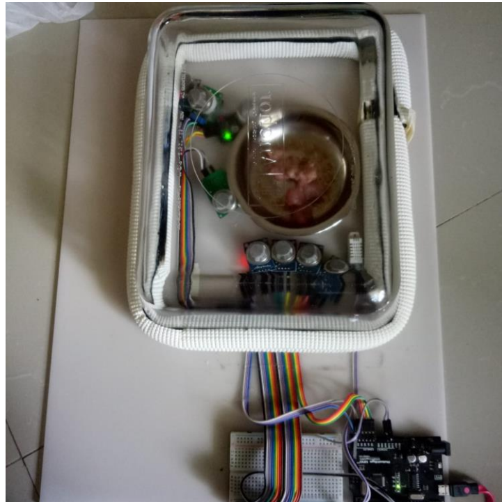
Gambar 5.2 Proses pengambilan data daging menggunakan electronic nose dengan suhu ruang dan suhu -22^{\circ}\text{C}
