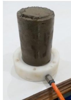
Gambar 4.5 Campuran dan Hasil Slurry (LL = 30%) (Sumber: Dok. Pribadi)
