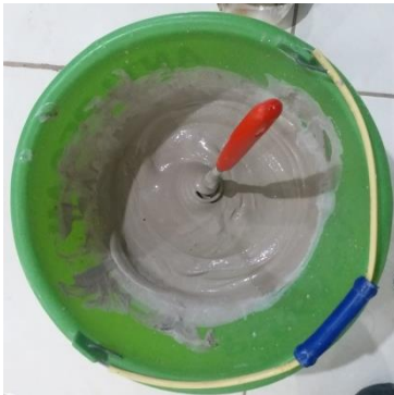
Gambar 4. 6 Campuran dan Hasil Slurry (LL = 60%) (Sumber: Dok. Pribadi)
