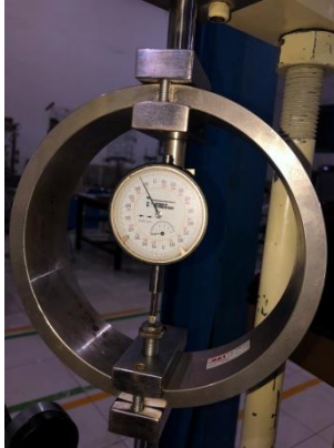
Gambar 4. 20 Pemberian Tekanan Air + Beban Axial/Normal (Sumber: Dok. Priibadi)
