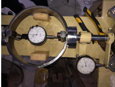
Gambar 4. 18 Dial Di- set dalam Keadaan Nol (Sumber: Dok. Pribadi)
