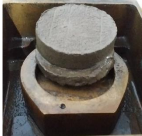
Gambar 4. 10 Persiapan Benda Uji untuk 100% Cracked ( u = 0 \text{kg/cm}^2 ) (Sumber: Dok. Pribadi)
