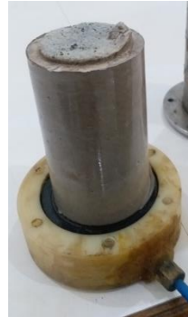
Gambar 4.7 Campuran dan Hasil Slurry (LL = 90%) (Sumber: Dok. Pribadi)
