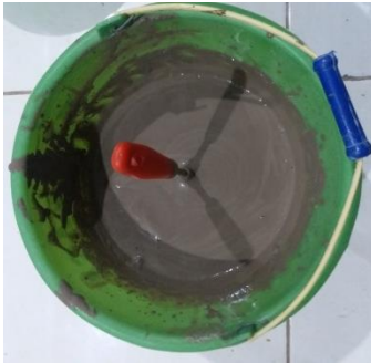
Gambar 4.7 Campuran dan Hasil Slurry (LL = 90%) (Sumber: Dok. Pribadi)
