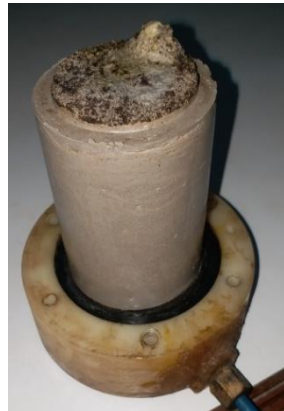
Gambar 4. 6 Campuran dan Hasil Slurry (LL = 60%) (Sumber: Dok. Pribadi)
