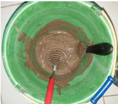
Gambar 4.5 Campuran dan Hasil Slurry (LL = 30%) (Sumber: Dok. Pribadi)
