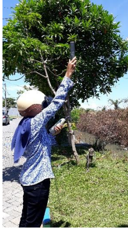
Gambar 7.1 Pengukuran Konsentrasi CO 2
