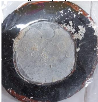
Gambar 4. 12 Saringan Bagian Bawah Reaktor Tanpa Penggunaan Seed Material Kecepatan 3,4 \times 10^{-3} m/s
