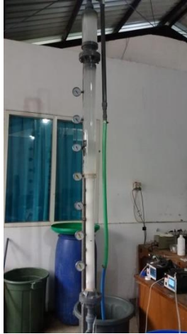
Gambar 2. Proses Recovery Fosfat dengan Reaktor Fluidized Bed
