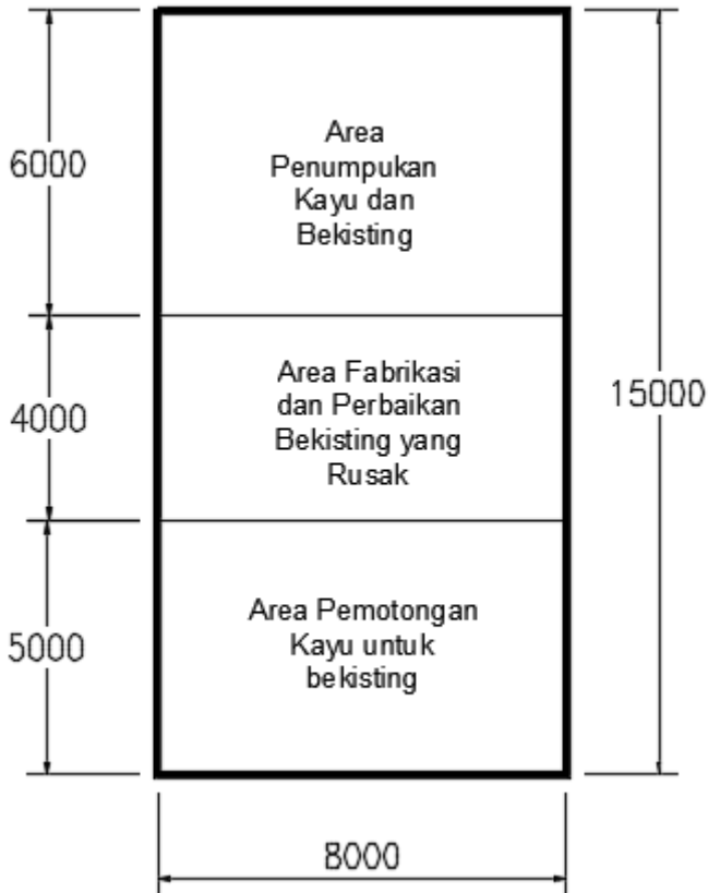
Gambar 4.9 Rencana Layout Stockyard dan Area Fabrikasi Bekisting
