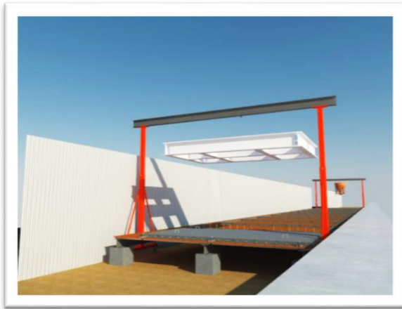
Gambar 4. 33 Pengangkatan Plat Precast HS menggunakan Gantry Crane
