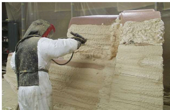
Gambar II. 23 Proses pingisian busa pada kulit kapal
