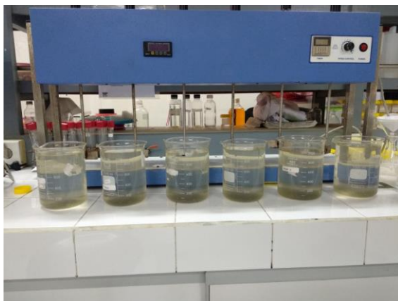
Gambar 4. 6 Hasil penurunan kekeruhan dengan jartest variasi PAC
