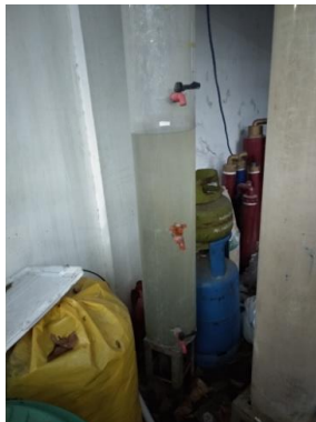
Gambar 4. 8 Percobaan sedimentasi tipe II dengan settling column test
