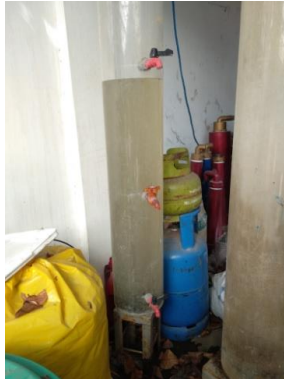
Gambar 4. 7 Percobaan sedimentasi tipe I dengan settling column test
